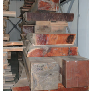
上 建築材（ケヤキ） 下 ケヤキテーブル用3枚高さ7m幅1m 天然乾燥5年
