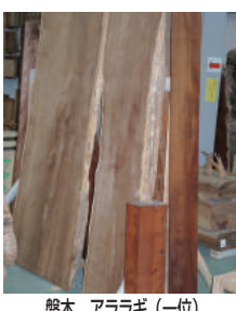
盤木 アララギ（一位） 樹齢1,000年天然乾燥20年以上 熊本県五木村産
